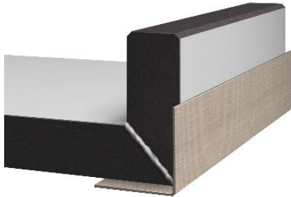
Abbildung 18: Aufkantung hochklappen und mit einem Klebeband befestigen
