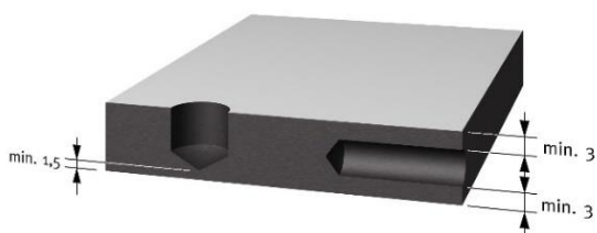
Abbildung 5: Mindestabstände der Bohrlöcher zum Plattenrand
