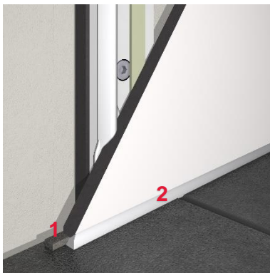
Abbildung 32: Bodenbündige Montage für den Duschbereich
