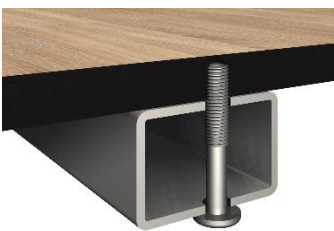
Abbildung 40: Empfohlene Befestigung der Kompakttischplatte
