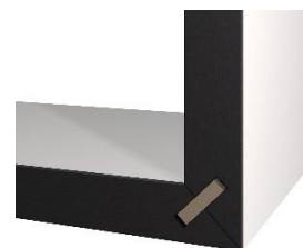
Abbildung 11: Nut und Feder
