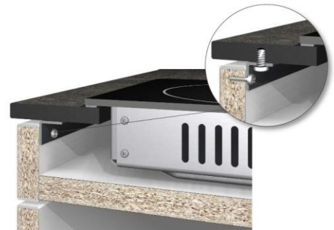
Abbildung 51: Stabilisierung mit Metall-Traverse
